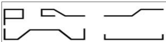
Рис. 5 Формы изгиба арматуры
