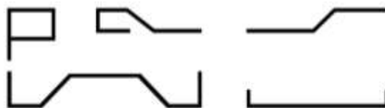
Рис. 5 Формы изгиба арматуры
